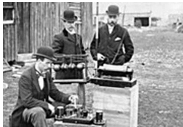
Gli ingegneri dell'ufficio postale britannico ispezionano il trasmettitore (al centro) e il ricevitore (in basso) di Marconi a Flat Holm, maggio 1897
