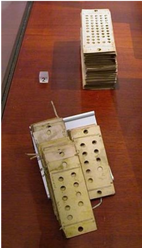
Schede perforate per la macchina analitica: le dimensioni corrispondono a diversi tipi, variable cards (più grandi, per le variabili) e operational cards (più piccole, per le operazioni)
