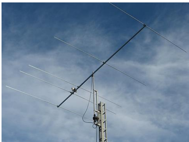
2 + 2 elementi Yagi per 2m (radiatore alimentato) e 70cm (radiatore Open Sleeve)
